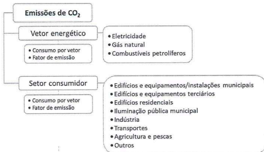
Figura 10 – Representação esquemática da metodologia de cálculo do Inventário de emissões de CO 2 .
